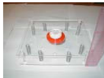
押しばねを利用した圧力実験器
